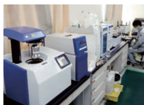
熱量計・燃焼イオンクロマトグラフィー
