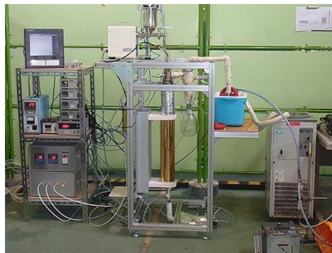
（実施例）透明電気炉を用いた受託試験装置
