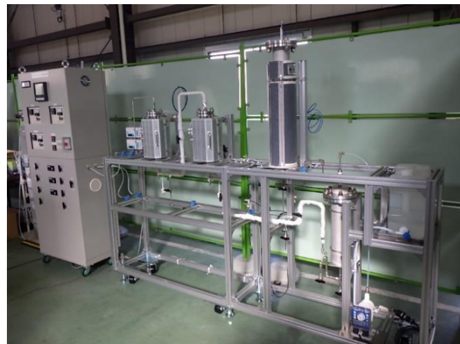
（実施例）メタネーション試験装置の製作
