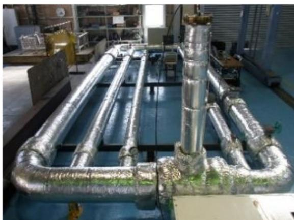
配管圧力損失試験
