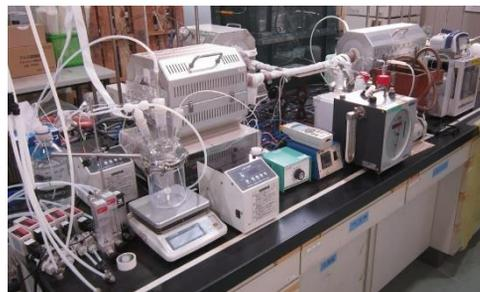
管状炉を用いた触媒実験
